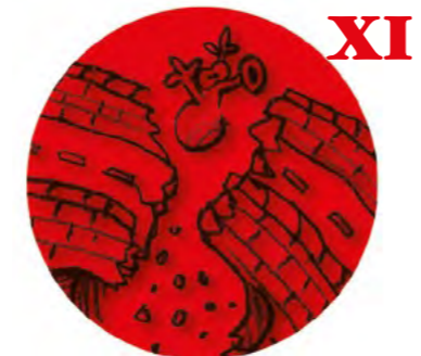
XI Catastrofico Crollano i ponti e quasi tutti gli edifici. Le rotaie si spostano, le tubazioni si rompono.
